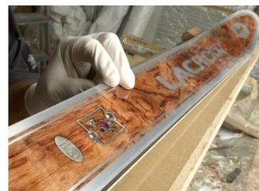
**RESOLTECH 1070S CLEAR / 1074** est un système époxy de stratification incolore formulé pour la fabrication de pièces composites transparentes avec une finition brillante de haute qualité, une bonne résistance aux UV et de hautes propriétés mécaniques.
