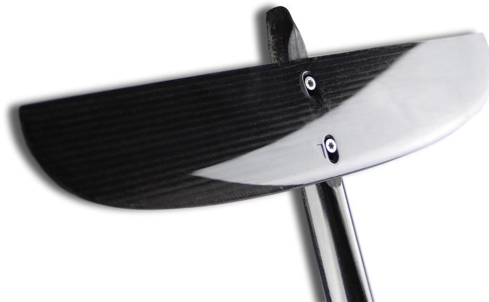
Les trous oblongs sur l'aile arrière permet de régler le V longitudinal du foil. Il permet de régler la pression à appliquer sur la jambe arrière pour décoller en fonction du vent et de la voile utilisée. Vous noterez qu'un témoin moulé dans la masse à côté de la vis avant permet de connaître ses réglages d'une session sur l'autre.
